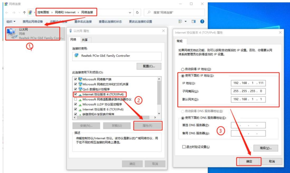
根据上图中的 ① ~ ③ 提示进行操作，给电脑设置一个静态 IP，使电脑 IP 跟支付控制器 IP 处于同一网段。
