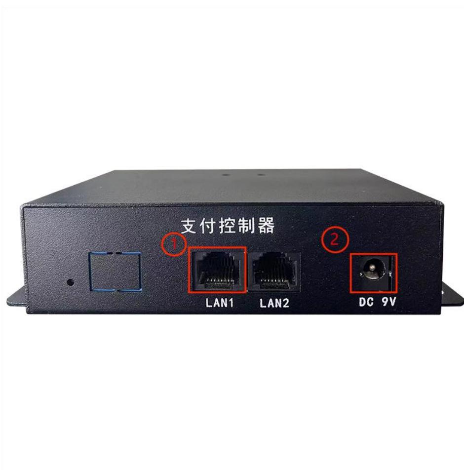
上图为支付控制器前视图，① 为支付控制器网口，② 为电源接口。修改支付控制器网络配置时，可采用直连电脑的方式，网线一端接支付控制器 LAN1 口，另一端接笔记本电脑/台式电脑。
