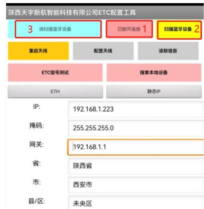
**ETC 信号测试:** 此功能主要用于测试设备对于车载 OBU 的读取能力是否正常。安装人员亦可使用此功能判断所安装设备的读取覆盖范围是否覆盖住停车场出口车道。使用方法即为：安装人员可将装有车载 OBU 的车辆停靠在停车场出口车道，然后点击“ETC 信号测试”按钮，然后查看 ETC 测试结果。如下图：
