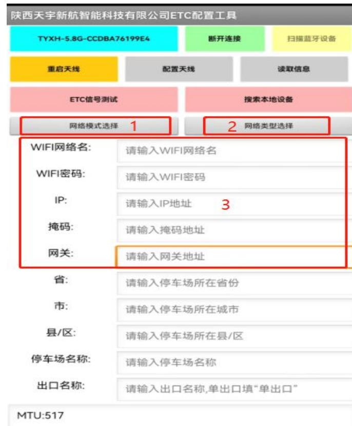
**应用设备信息:** 当完成设备信息的编辑后, 点击“配置天线”后再点击“重启天线”应用设备信息。**注意: 应用设备信息必须重启天线**
