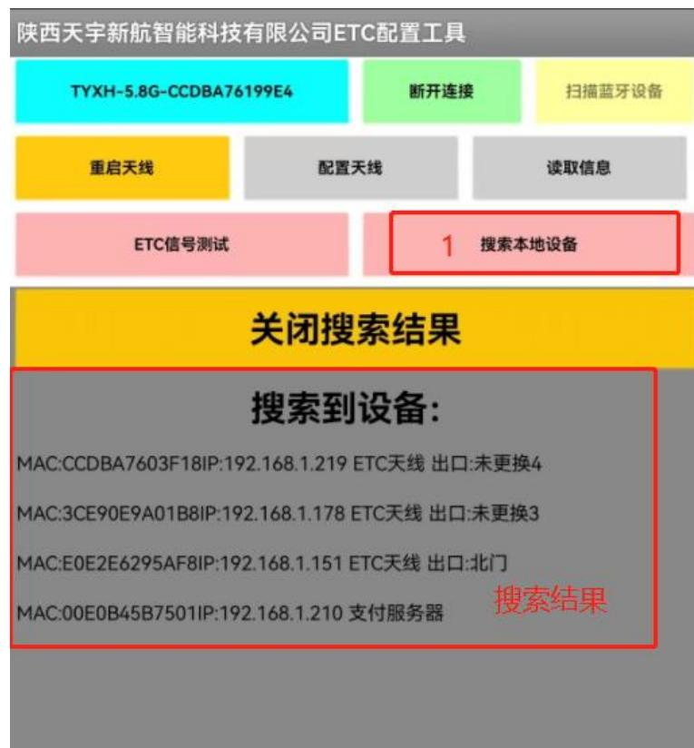
搜索结果中进行设备 IP 更改：1、选中要更改的设备 2、读取设备当前的配置 3、填写配置信息 4、点击“配置” 5、点击“重启并应用配置”
