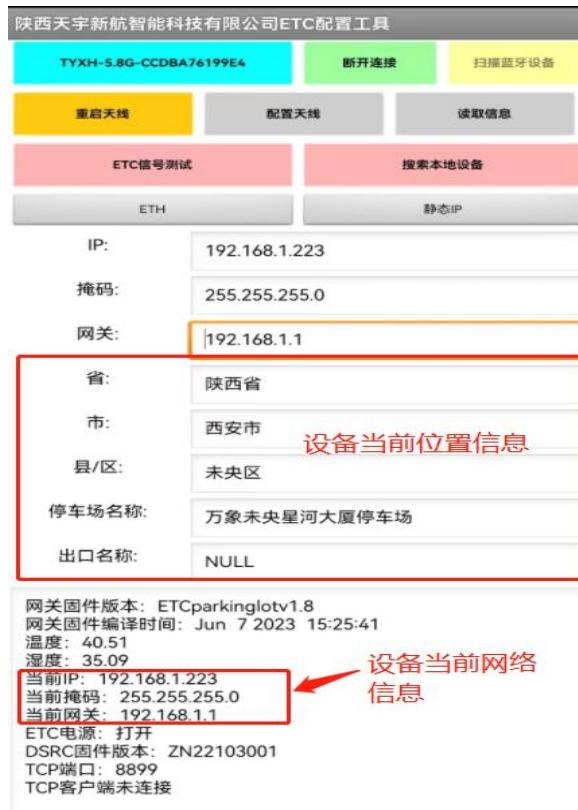
**网络信息修改：**设备的网络信息可根据停车场现场的实际情况进行更改。网络模式可选择：ETH（有线）或 WiFi；网络连接类型可选择：自动获取 IP 或静态 IP。选择确定后在下方输入框输入网络信息即可。
